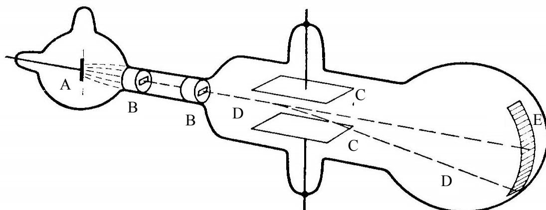
Ismertesse az ábra segítségével a katódsugárkör felépítését és működését! Használja az ábra jelöléseit! Mutassa be, hogy milyen irányú elektromos tér teríti el az elektronsugarat az ábra szerinti kísérletben! Magyarázza el, hogy milyen irányú mágneses tér tudná kompenzálni az elektronok eltérülését! (Jelölje be az ábrán is!) Az elektron milyen fizikai jellemzője mérhető a katódsugárkör segítségével?
